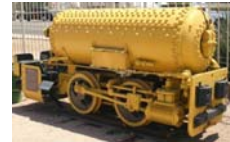
Locomotora de Homestake Mining ( Dakota del Sur, USA ), funcionaba con aire comprimido y se usaba para minas. (1928 – 1961)
