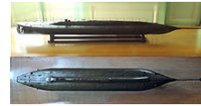
El primer submarino propulsado mecánicamente utilizaba, the 1863 Plongeur, usaba una máquina de aire comprimido Musée de la Marine (Rochefort).
